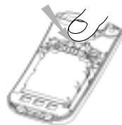
Premere sul supporto per liberare la batteria
