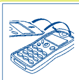
Inserire la parte superiore del pannello
